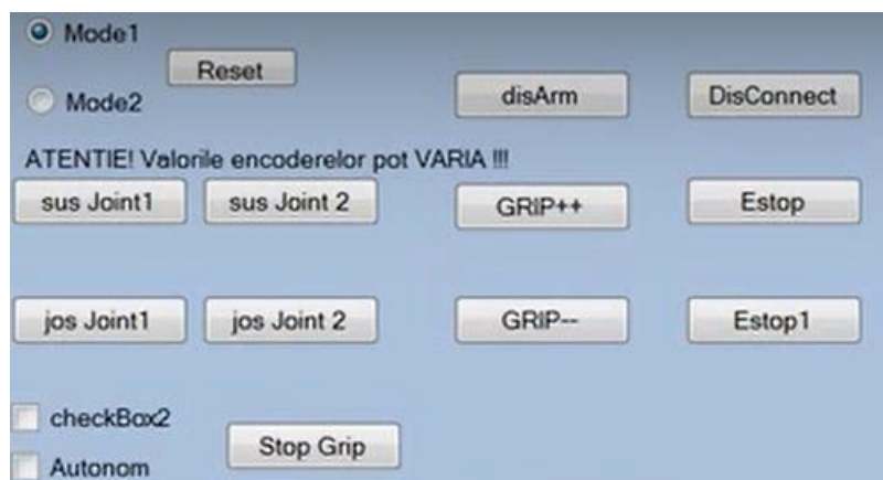
Figură 46 Dispunerea în interfață a butoanelor de control al brațului robotic.
