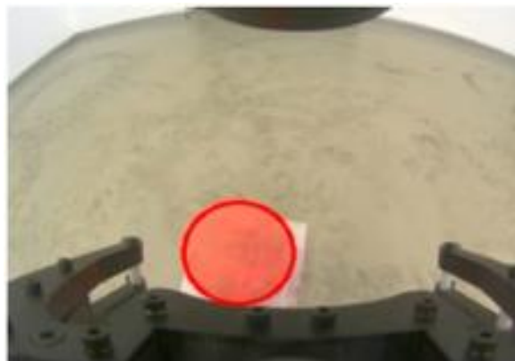
Figură 38 Detecția de cercuri folosind transformata Hough.
