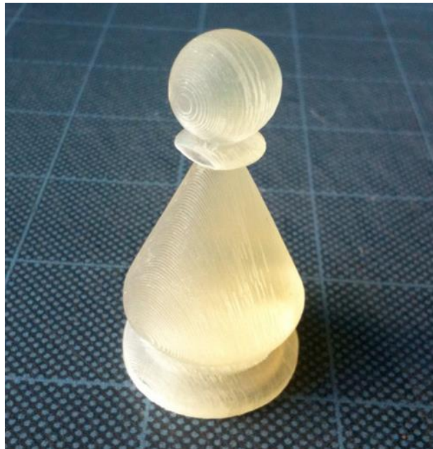
Figura 2.5 Obiect realizat prin tehnica LOM [12]
