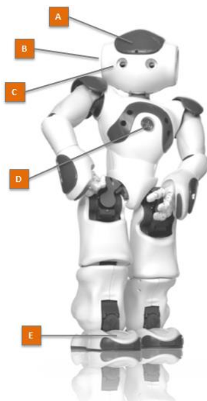
Figura 2.6: Locația LED-urilor de care dispune robotul NAO [1]
