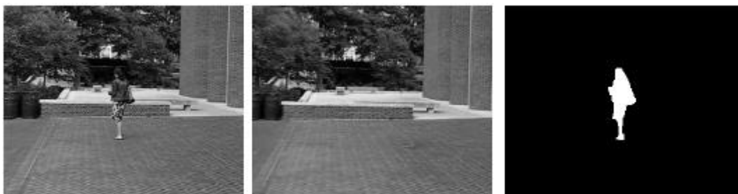
Figura 2-3 Detecția mișcării folosind diferența dintre imagini
