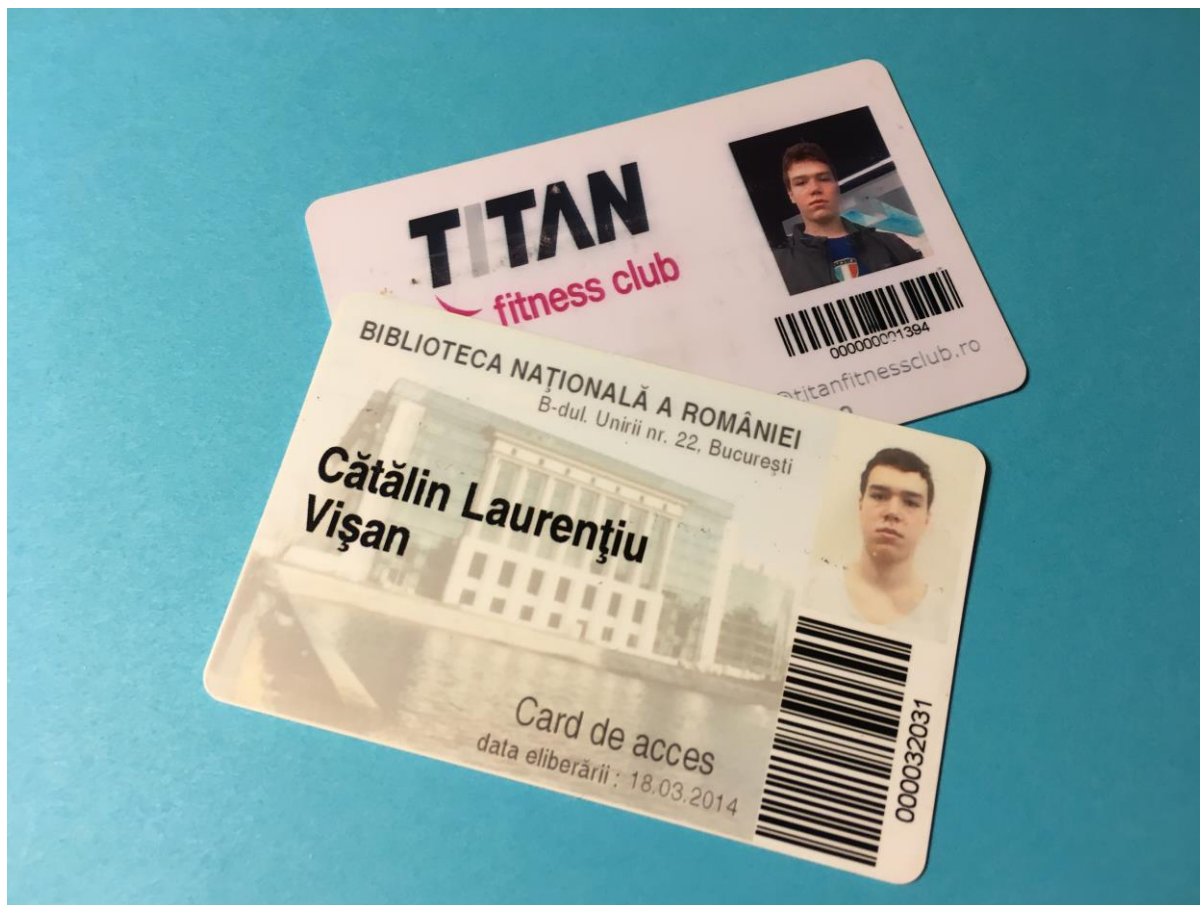
Imaginea 3.6: Legitimații de acces cu taguri RFID integrate
