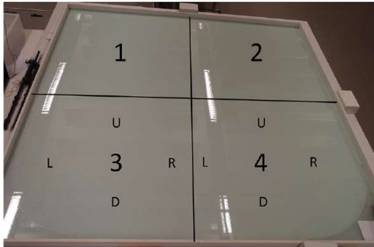
Figura 2.4: Arena kiloboților din laboratorul de robotică al universității din Sheffield. [7]
