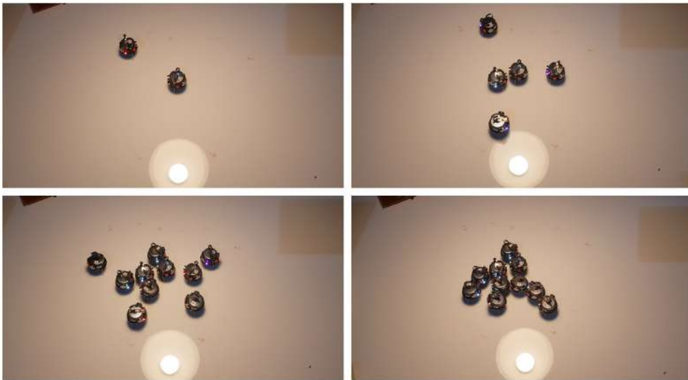
Figura 3.3: Algoritmul Strângere cu 1 robot de tip beacon .
