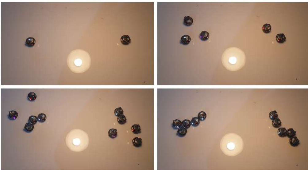
Figura 3.4: Algoritmul Strângere cu 2 roboți de tip beacon .
