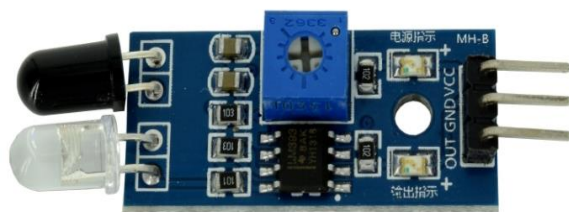
Figura 3.6: Modul senzor infraroșu de obstacole; Sursa [22]
