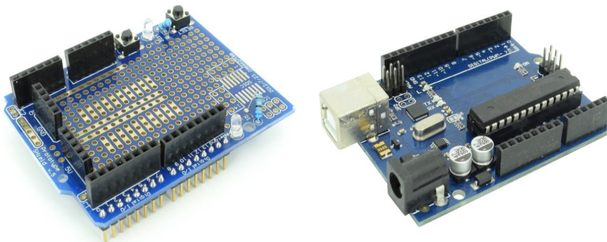
Figura 3.9: Placa Arduino UNO R3 și placă prototip compatibilă cu aceasta ; Sursa: Optimus Digital
