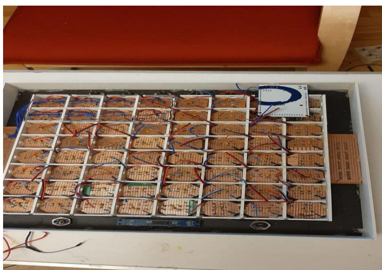
Figura 5.14 – Lipirea componentelor electronice și introducerea plăcilor de perfoboard echipate în interiorul tablei de șah
