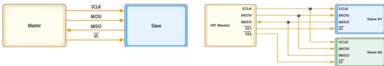
Exemplul 1 - comunicare SPI dintre un dispozitiv "master" si un dispozitiv "slave"
