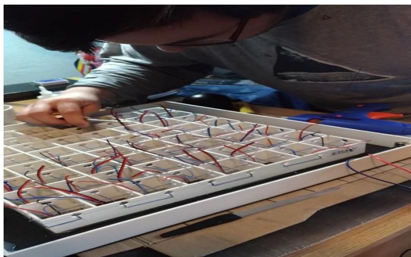
Figura 5.13 - Introducerea senzorilor pe partea inferioara a placii de plexiglas
