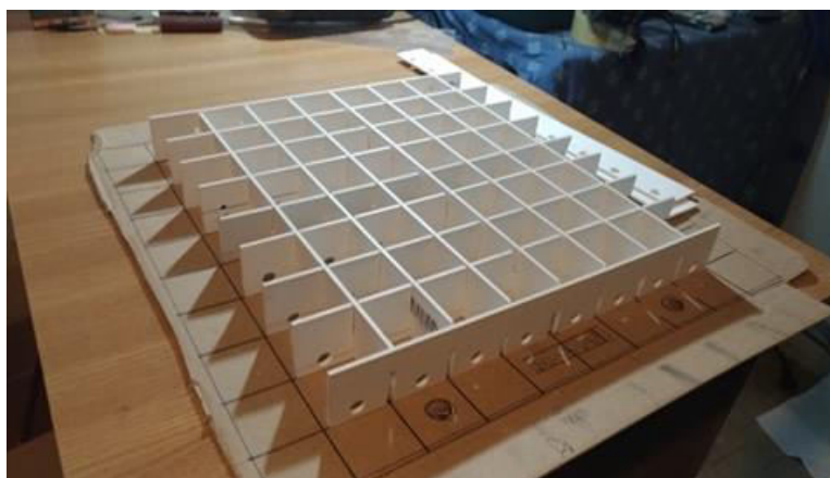
Figura 5.10 – Structură tip fagure realizată din benzi de plastic alb ABS
