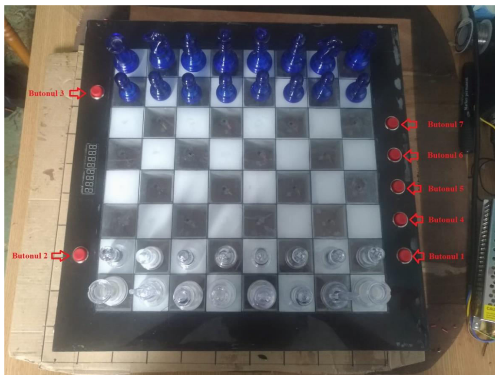
Figura 3.7 – Identificarea butoanelor pe tabla de șah inteligentă
